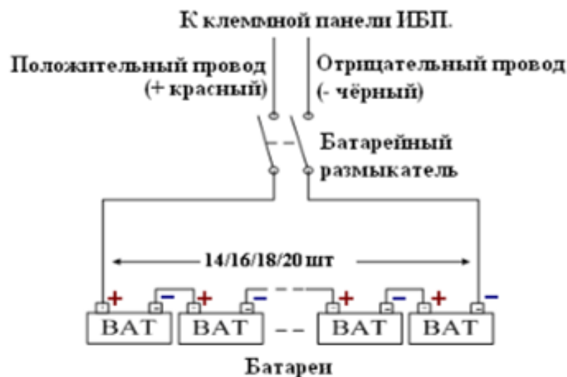
Подключение батарей к моделям ИБП ProVision Black M P 10-30кВА LT (3ф/3ф)
